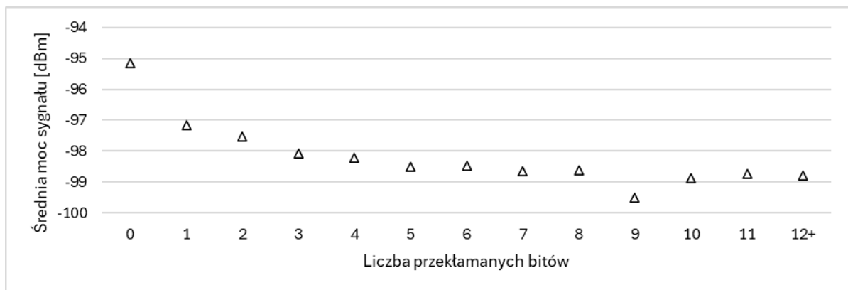
Rys. 3.11 Średnia moc sygnału dla ramek ze wskazaną liczbą przekłamanych bitów
